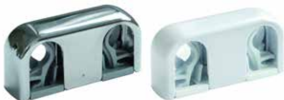
Purus-klamman Flexi Rörklamman klarar rör från ø 10 mm upp till ø 16 mm i samma hållare. Hållaren har en fjäderbelastad funktion som låser röret när överdelen monteras
